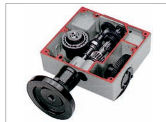
Code 30003: Descente automatique mécanique de la broche 3 vitesses 0,05 – 0,1 – 0,2 trs/min (R32 – R40).
