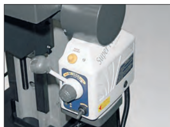
Code 40026 Power: Avanzamento automatico longitudinale meccanico della tavola.
