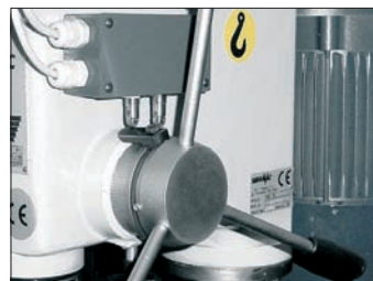
Cod. 18080: Taraudage par téléinverseur
