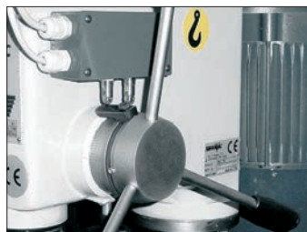
Cod. 18080: Filettatura con teleinvertitore.
